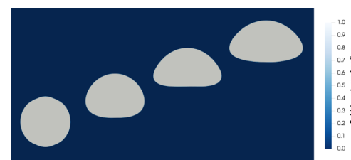
Vier snapshots uit een Briscola simulatie van een stijgende bel die zich vervormt. Dit soort vervormingen komen voor in de foto links.
